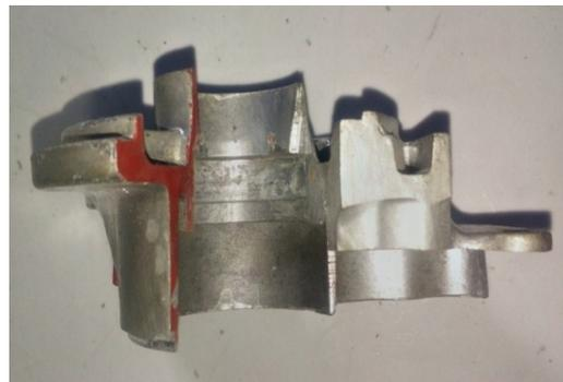
Gambar 7 Hasil Potongan *Body Pinion*
