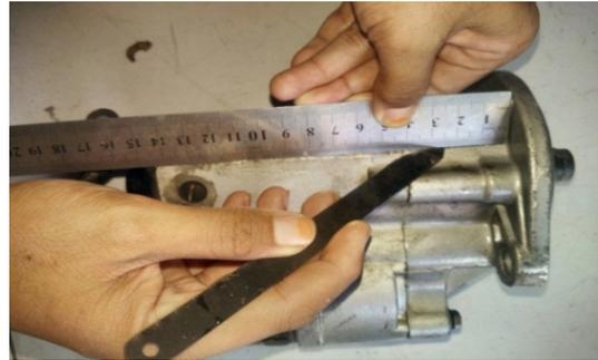
Gambar 2 Memberi Tanda Garis pada *Pinion Gear Case*
