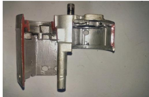
Gambar 6 Hasil Potongan *Body Reduksi*
