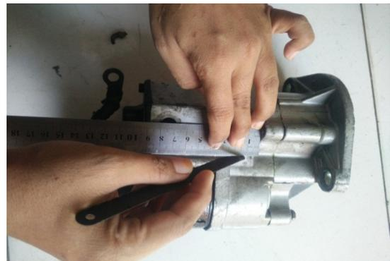
Gambar 3 Memberi Tanda pada Reduksi *Gear Case*
