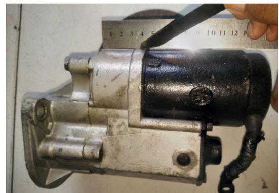
Gambar 4 Memberi Tanda pada *Armature Case*
