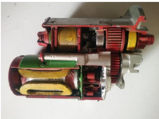
Gambar 10 Hasil Peraga dari Motor *Starter* Mesin Diesel
