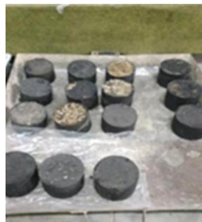
**Gambar 2.** Benda Uji untuk *Marshall Test*
