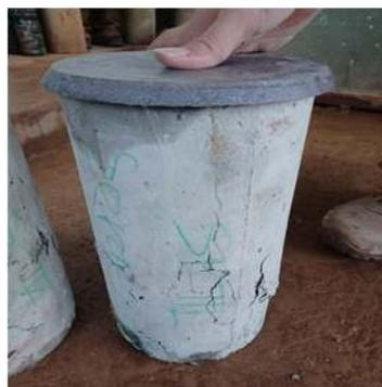
**Gambar 7.** Pola Retak Beton SP 3.
