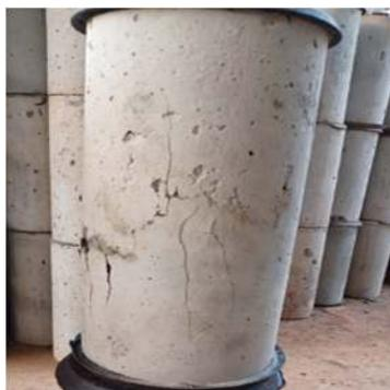
**Gambar 6.** Pola Retak Beton SP 2.
