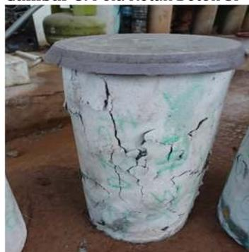
**Gambar 9.** Pola Retak Beton SP 5.
