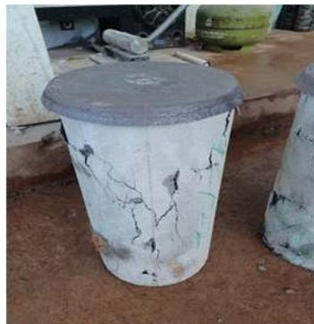
**Gambar 8.** Pola Retak Beton SP 4.
