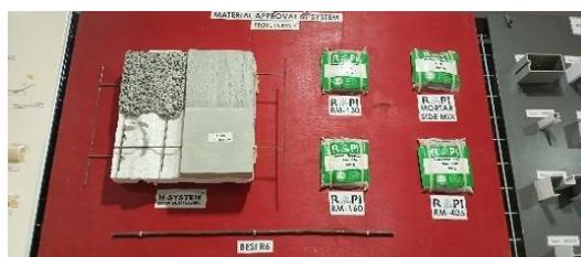
**Gambar 3.** Lapisan Tengah Dinding Menggunakan Styrofoam.
