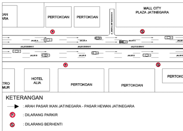
Gambar 7. Ilustrasi Lokasi Pemasangan Rambu lalu Lintas
