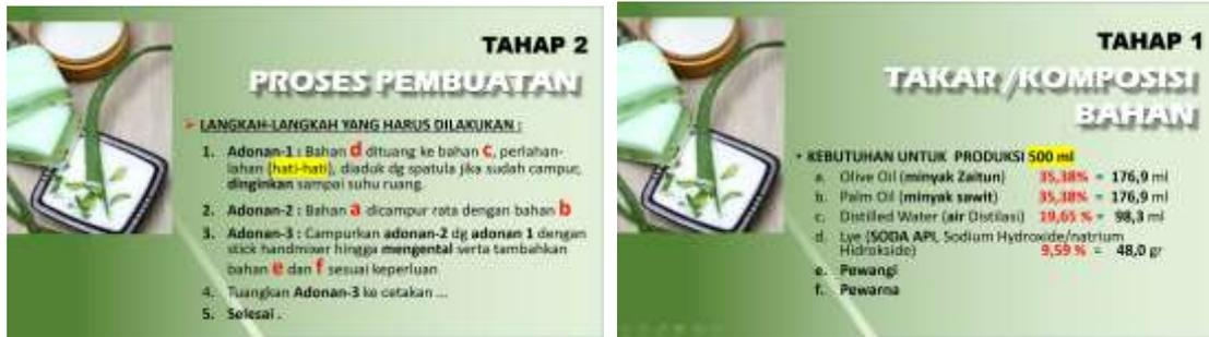
Gambar 5. Tahapan proses pembuatan sabun
