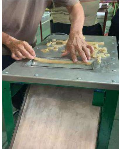
**Gambar 2.** Mesin pemotong kulit sapi
