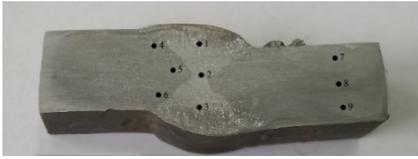
Gambar 17. Titik yang di uji keras pada spesimen non
