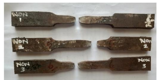
Gambar 15. Spesimen non setelah diuji tarik
