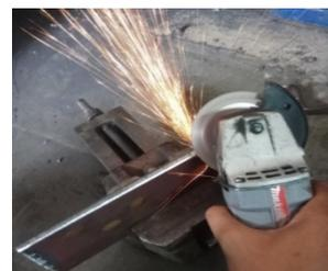
Gambar 2. Proses pembuatan kampuh X
