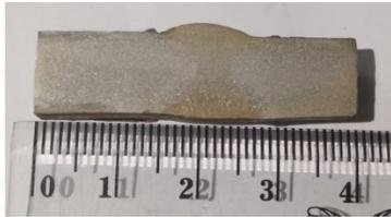
Gambar 19. Foto struktur makro spesimen krom
