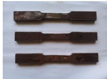
Gambar 8. Spesimen uji tarik dengan penambahan krom
