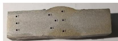
Gambar 16. Titik yang di uji keras pada spesimen krom
