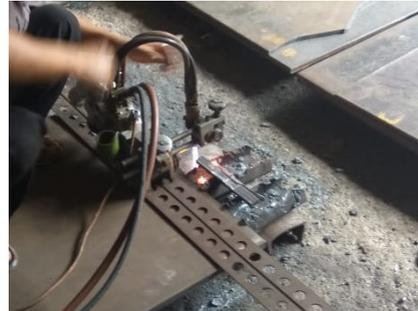
Gambar 7. Proses pemotongan spesimen uji tarik
