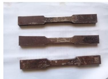
Gambar 9. Spesimen uji tarik tanpa penambahan krom
