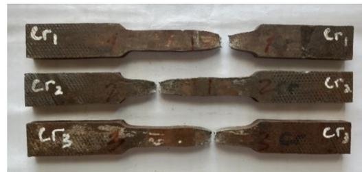
Gambar 14. Spesimen krom setelah diuji tarik
