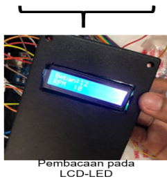
Gambar 13. Hasil kalibrasi program Arduino_UNO dan pembacaan pada LCD-LED
