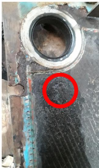
Gambar 2. Kebocoran pada *frame* bagian belakang alat penukar kalor pelat datar UFX-42H
