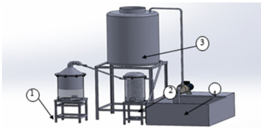
Gambar 1. Sistem destilasi minyak atsiri
