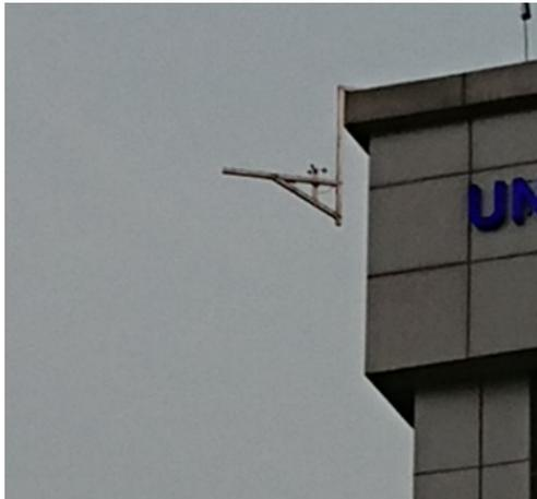
Gambar 7. Set up experiment pengambilan data kecepatan angin pada sisi siku gedung
