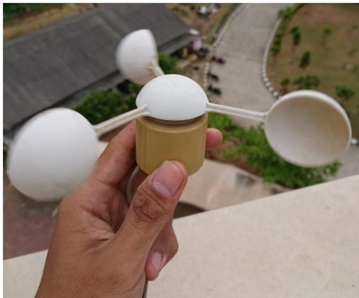
Gambar 8. Anemometer cup sebagai tools pengambilan data kecepatan angin
