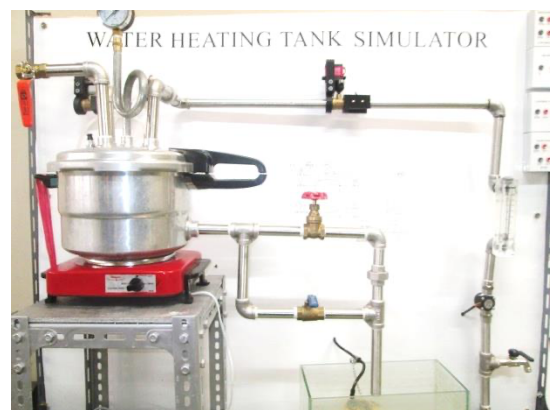
Gambar 5. Realisasi simulator tangki pemanas
