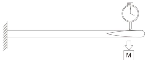
Gambar 10. Setup pengujian momen puntir
