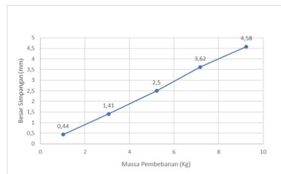
**Gambar 12.** Data pengujian momen puntir sudu bermaterial serat karbon
