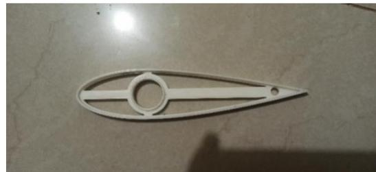
Gambar 7. *Airfoil* NACA-S1046 yang telah dimodifikasi
