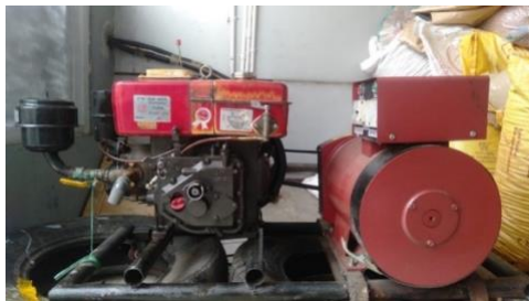
Gambar 5. Genset diesel (Lab. Rekayasa Energi Baru Terbarukan)
