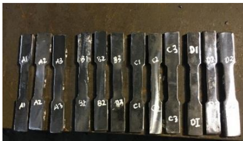
Gambar 4. Pembuatan sampel untuk pengujian tarik
