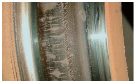
Gambar 1. Kerusakan permukaan roda yang disebabkan oleh rem blok
