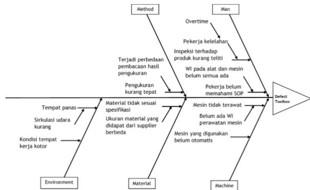
Gambar 7. Fishbone diagram cacat produk toolbox
