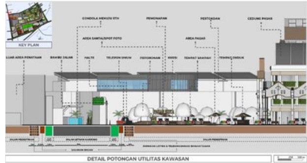
Gambar 30. Detail Potongan Utilitas Kawasan
