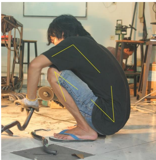
Gambar 7 Pekerja bagian Pematangan dan penghalusan pipa besi
