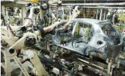
Gambar 1. Proses FSSW oleh Mazda Motor Corporation dan Kawasaki Heavy Industri [1]
