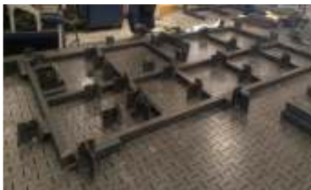
Gambar 6. Welding JIG pembuatan frame
