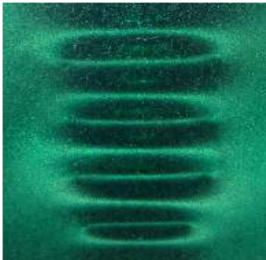
Gambar 5. Flux magnet pada main shaft
