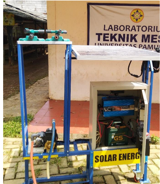
Gambar 2. proses pengisian aki dengan panel surya
