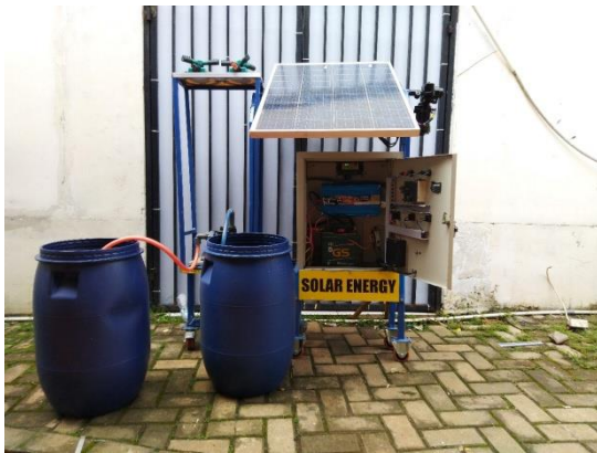
Gambar 3. pemakaian aki untuk menggerakkan pompa AC sehingga mendapat debit air
