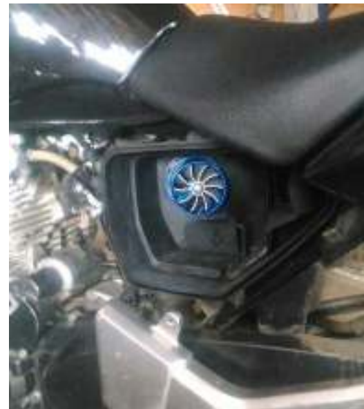
Gambar 2. Pemasangan Turbo Ventilator pada Inlet Filter Case
