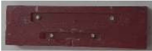
Gambar 6. Cetakan Spesimen Uji Impak dan Tekuk
