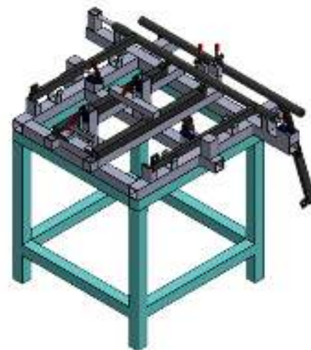
Gambar 8 Optimasi Desain Welding Jig Pengangkat Bawah
