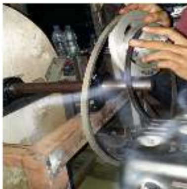
Gambar 17. Pemasangan double pulley
