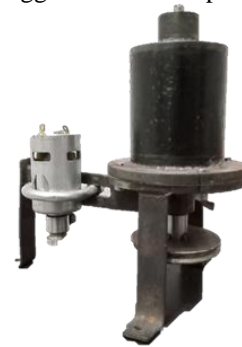
Gambar 1. Rakitan pompa dan motor penggerak
