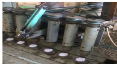
**Gambar 10** Pengujian Pengerboran Pada Gabus Shuttlecock
