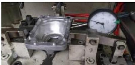
Gambar 15. Pengecekan Kestabilan Jig
