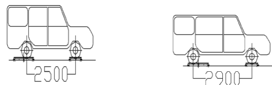
Gambar 4. Jarak Antar Sumbu
