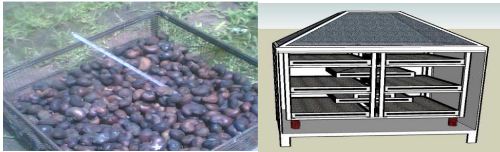
Gambar 2 Letak kacang mete di atas rak pengering dan bentuk ruang pengering
