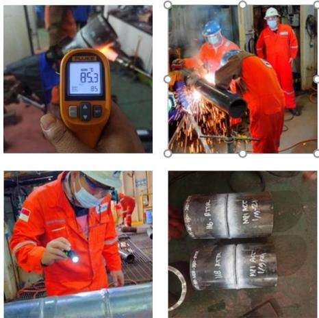
Gambar 5 Proses pengelasan SMAW pada pipa size 6 inci
