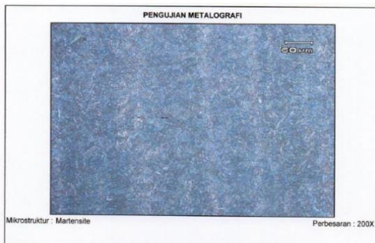
Gambar 6. Hasil uji Metalografi pada material pegas daun
