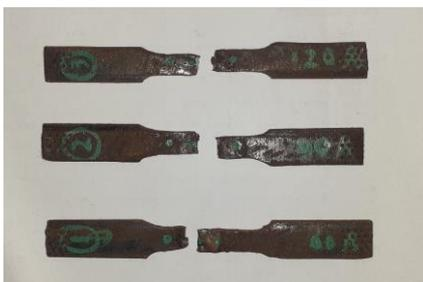
Gambar 8 Spesimen yang telah di uji tarik
