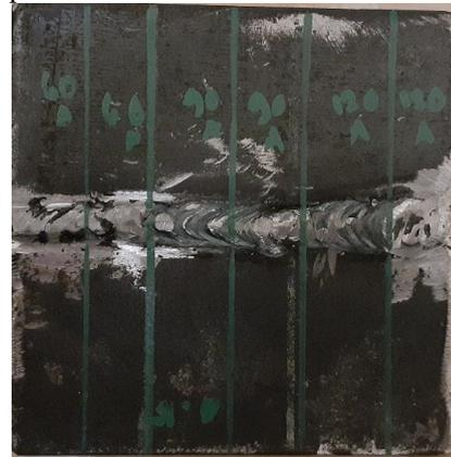
Gambar 5. Hasil pengelasan spesimen
