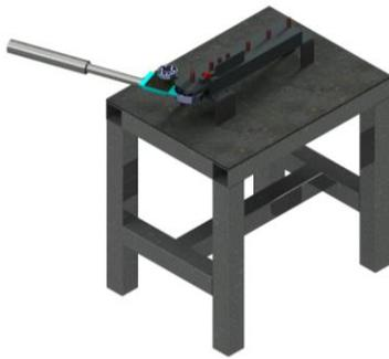
Gambar 4. Perancangan alat tekuk behel manual
