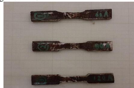
Gambar 6. spesimen uji tarik
