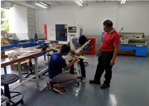
Gambar 5. Proses pemasangan blade
