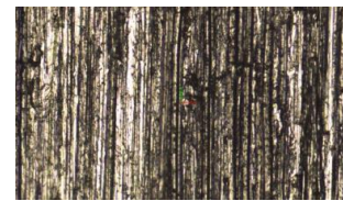
Gambar 9. Hasil Pengujian Metalografi R_a 5,713 \mu\text{m}
