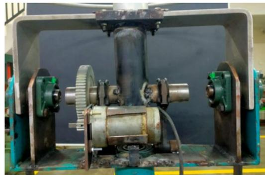
Gambar 4. Modul Penggerak *Concentrated Solar Power*
