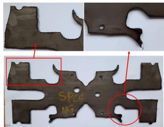
Gambar 5. Hasil laser cutting untuk material SPHC dengan menggunakan parameter tidak ideal
