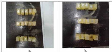
Gambar 9 (a) Spesimen Sebelum Pengujian Tekan (b) Spesimen Sesudah Pengujian Tekan.
