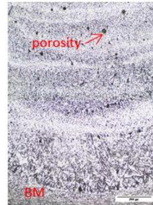
Gambar 10 Struktur mikro manik las ( bead ) dengan Arus 100A
