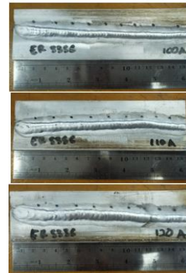
Gambar 7 Manik las TIG dengan filler ER 5356 arus 100A,110A, dan 120A- Layer3
