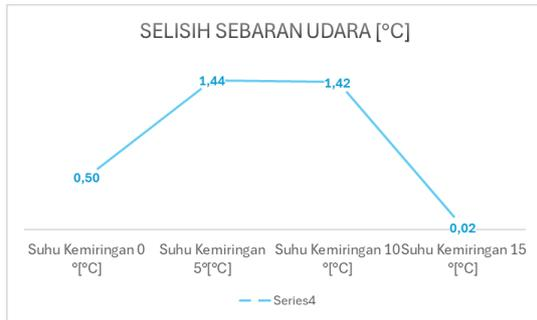
Gambar 15. Hasil Grafik selisih suhu max dan min keseluruhan hasil *drying chamber*
