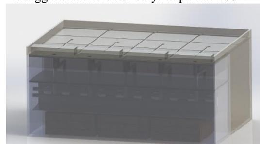
Gambar 2. Bangunan pengering kayu menggunakan kolektor surya kapasitas  $120 \text{ m}^3$
