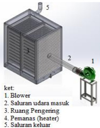
Gambar 1. Komponen Alat Pengering tipe rak bertingkat ( tray dryer )
