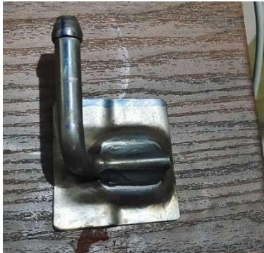
Gambar 7 Sampel Uji Penetrasi.
