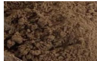
Gambar 10 . Serpihan kertas yang terdapat pada Lubang Mesin Corrugator
