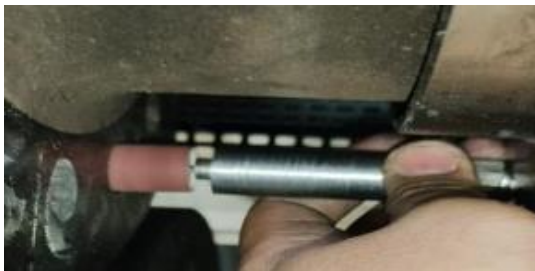
Gambar 9 Profil Alat Pembersih Lubang Mesin Corrugator
