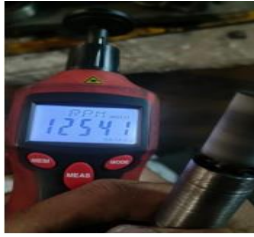
Gambar 8 Hasil pengukuran menggunakan tachometer
