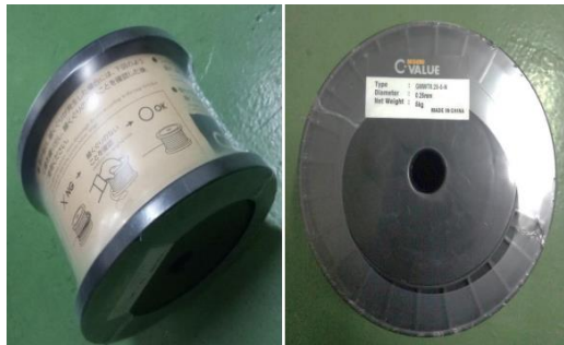
Gambar 4 Tipe gulungan kawat elektroda
