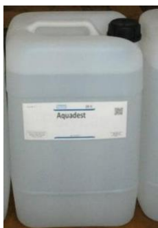
Gambar 5 Cairan dielektrik aqua destila
