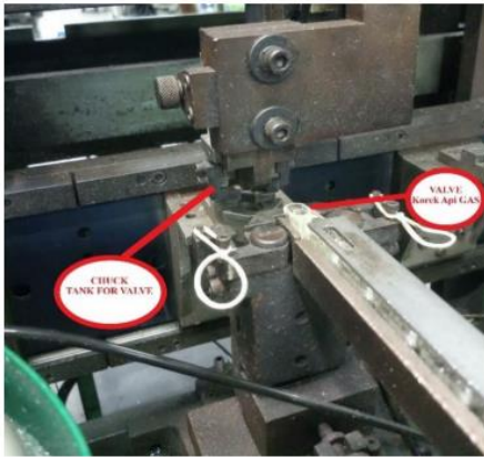
Gambar 2 Penggunaan Chuck TFV pada mesin Assembling Tank For Valve
