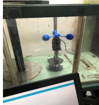
**Gambar 10 Penempatan Anemometer**
