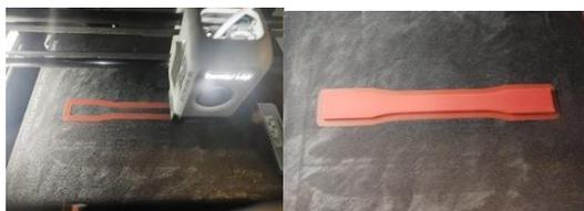
Gambar 5 Proses Cetak 3D Printer
