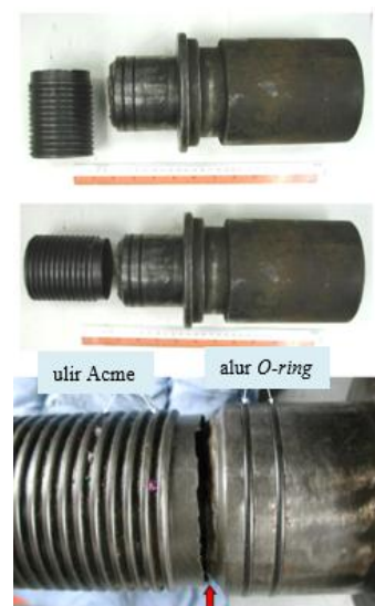
Gambar 1: Kegagalan pada Connector
