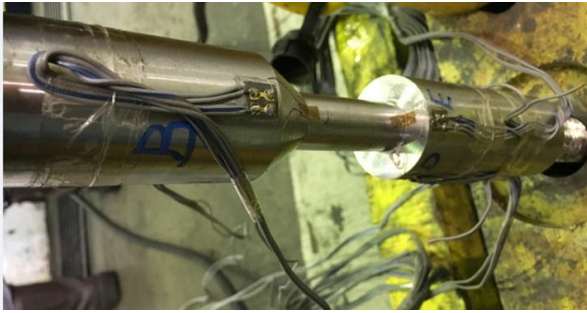
Gambar 14 lokasi penempelan strain gauge dan penomoran channel -nya.
